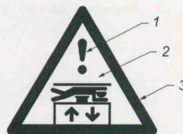
Рисунок 1 — Знак «Опасность снизу — Ограниченное пространство — Соблюдайте осторожность»
